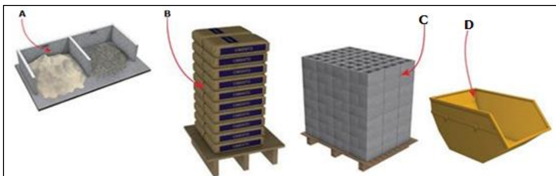
Figura 15. A) Baias de Agregados, B) Cimento, C) Blocos e D) Caçamba. Fonte: ACQUAPLAN, 2017.
